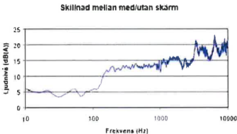
Figur 6.10 FFT-spektrum som beskriver skillnad i ljudtrycksnivå för tåg med och utan bullerskärm
