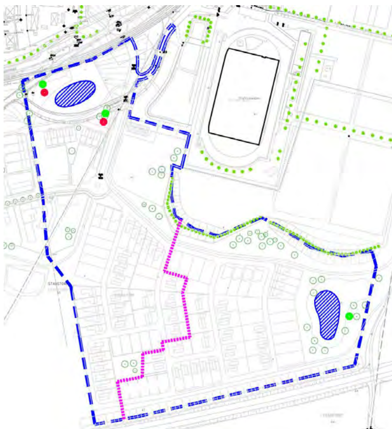
Figur 3. Förslag till placering av pumpstationer för dagvatten (grön punkt) och spillvatten (röd punkt).
