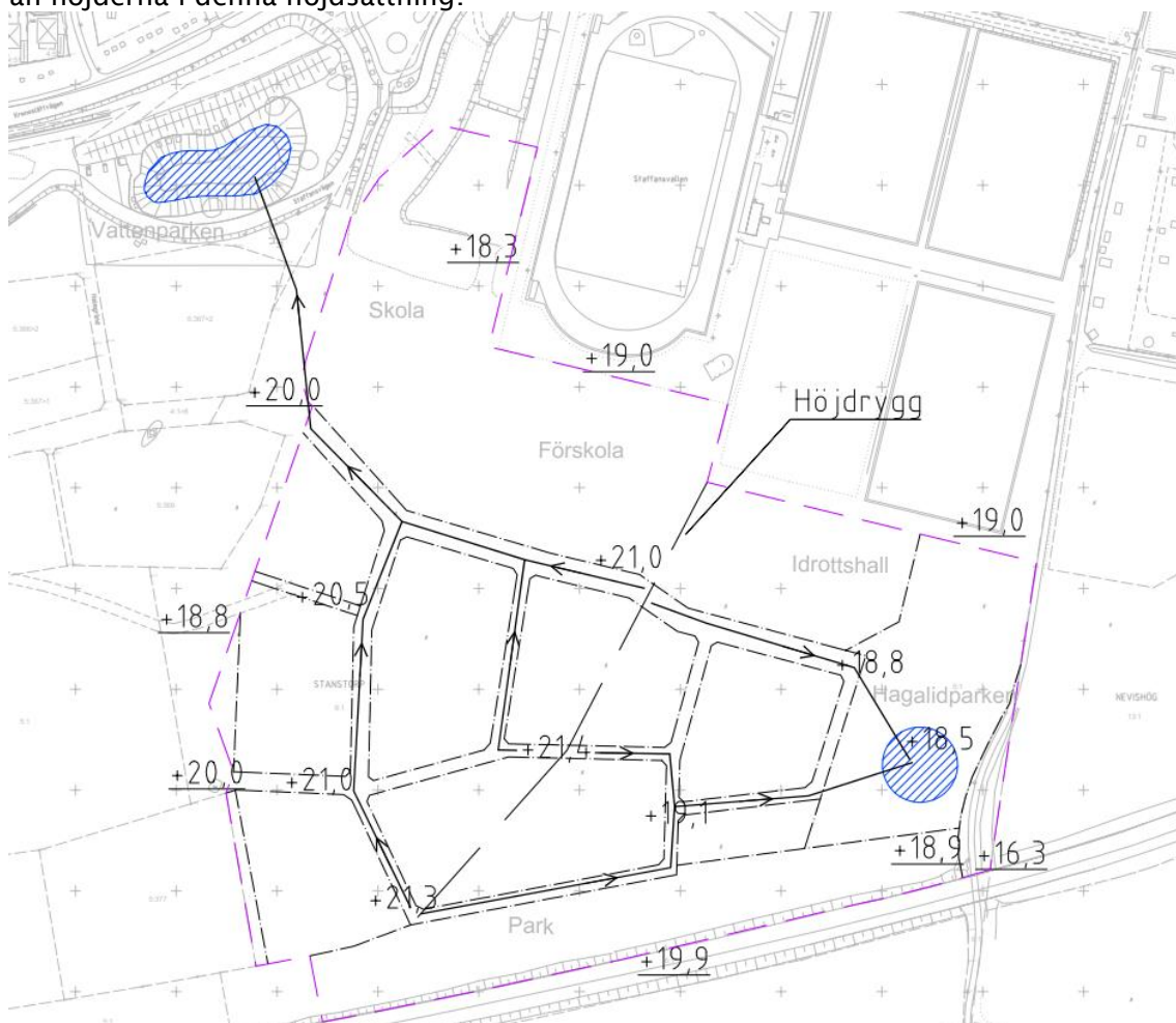
Figur 3 visar enkel höjdsättning med avseende på skyfall. Understruken markhöjd är befintlig höjd medan höjd utan understreck är ny markhöjd. Bilden finns som bilaga se Höjdsättning med avseende på skyfall.
