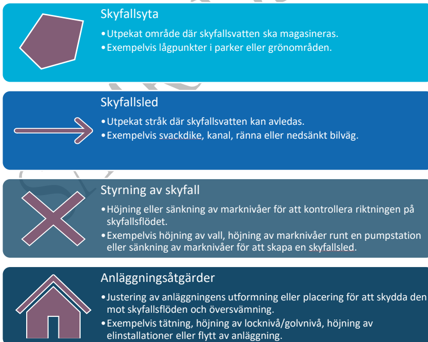
Figur 8. Schematisk illustration av effektiva skydd mot skador orsakade av översvämningar vid skyfall.
