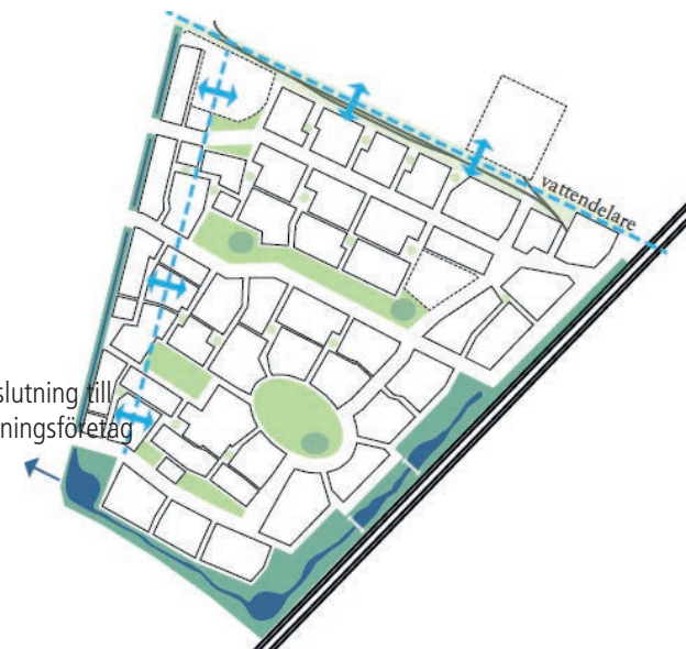
Figur 14. Principerna för avledningen av dagvatten från hela planprogramområdet.
