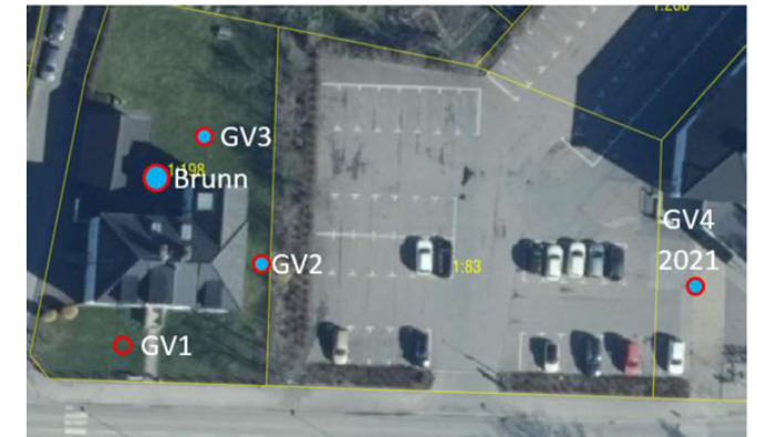
Figur 1. Borrpunkternas placering. Ringar med blå fyllning är grundvattenrör.
