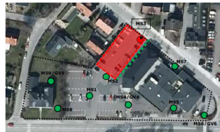
Figur 13. Bedömd maximal utbredning av påträffad förorening markeras med rött område. Röd punkt visar borrpunkt med halter över KM och gröna punkter visar halter under KM. (DeKa 2021).
