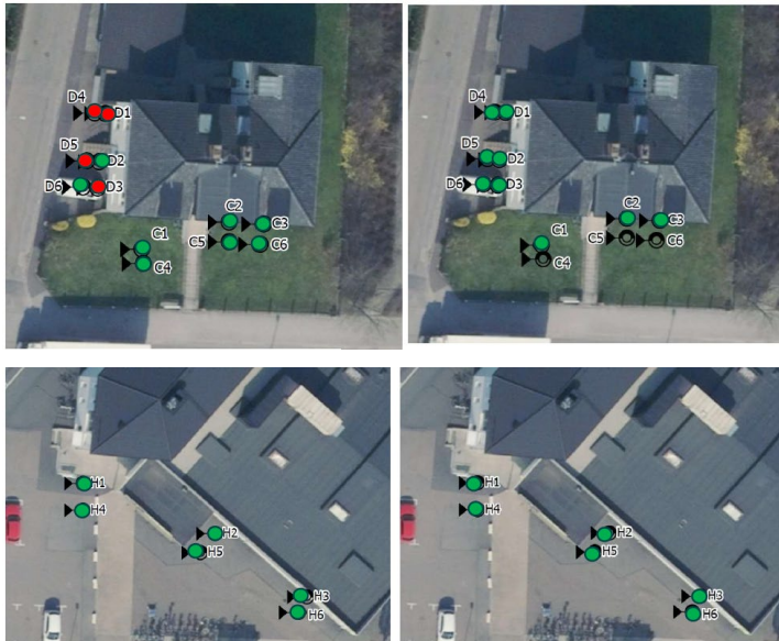
Figur 18 Rött visar halter över KM, grönt visar halter under KM. V1. Resultat 0-0,2m, fasad C och D. H1. Resultat 0,2-0,5m, fasad C och D. V2. Resultat 0-0,2m, fasad H. H2. Resultat 0,2-0,5m, fasad H.
