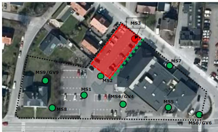
Figur 13 Bedömd maximal utbredning av påträffad förorening markeras med rött område. Röd punkt visar borrhpunkt med halter över KM och gröna punkter visar halter under KM
